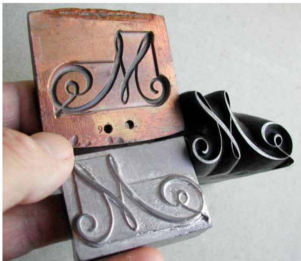
un poinçon et sa matrice d'imprimerie © http://www.tutoweb.be
